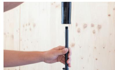
Durch die exzentrische Bauform muss der Schalldämpfer zum Lauf hin ausgerichtet werden.
