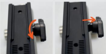
1. Aktivieren Sie den Verschlusshebel in dem Sie diesen um 10° nach links oder rechts drehen und dabei von der Montage wegziehen. Lösen Sie die Klemmbacken ihrer Montage durch Drehen der Verschlusshebel entgegen dem Uhrzeigersinn bis ein Aufkippen auf das Prisma möglich ist.
